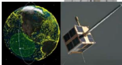
通信衛星(低速・高速・戦域) 高速通信・ISARA (3U) 低速通信・AISSAT-1 (6kg)
